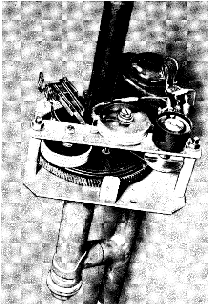
Bild 6. Ansicht der fertig montierten Grundplatte mit dem unteren Rotor-Achslager
