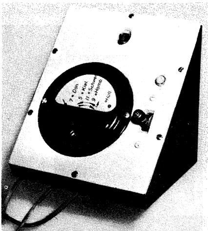
Bild 8. Bedienungskästchen mit Richtungsanzeigeelement, Wendeschalter (rechts), Signallämpchen (darüber) und Richtungs-Kontrolltaste (oben)
